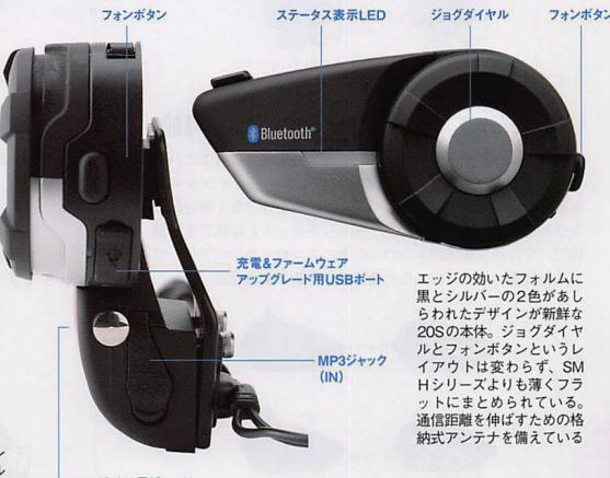
エッジの効いたフォルムに黒とシルバーの2色があしらわれたデザインが新鮮な20Sの本体。ジョグダイヤルとフォンボタンというレイアウトは変わらず、SMHシリーズよりも薄くフラットにまとめられている。通信距離を伸ばすための格納式アンテナを備えている
