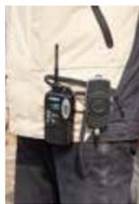
付属のベルトクリップを背面に取付けられ、トランシーバーと一緒にベルトなどに引っ掛けて持ち運べる
