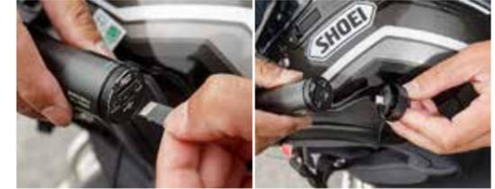
マイクロSDカードは本体後部のネジ式キャップを外してスロットに着脱する。このキャップはスピーカー&マイク用USBケーブルを使う場合、専用のものに取り換えて使う
