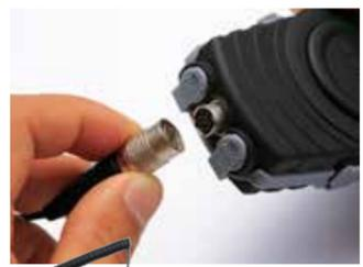
無線機専用ケーブルのコネクタはミニDINとなっていて、ロックがかかる構造のため抜けにくい
