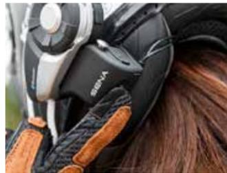
アンビエントモード起動は2回押しで本体のマイクから集音し周囲の音が聞きやすくなる。1回押しならボイスコマンドモード
