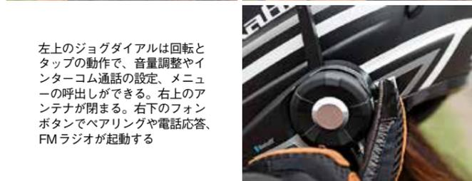
左上のジョグダイヤルは回転とタップの動作で、音量調整やインターコム通話の設定、メニューの呼出しができる。右上のアンテナが開まる。右下のフォンボタンでペアリングや電話応答、FMラジオが起動する
