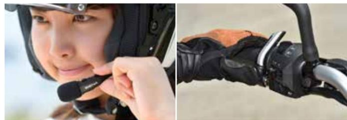
マイク部のボタンで音量などの操作が可能。ボタンも少し大きめに設計されていて、コチャもグローブしたまま操作しやすい
