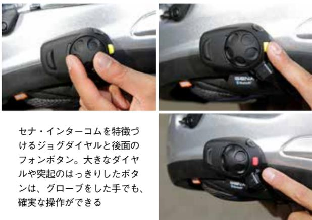
セナ・インターコムを特徴づけるジョグダイヤルと後面のフォンボタン。大きなダイヤルや突起のはっきりしたボタンは、グローブをした手でも、確実な操作ができる
