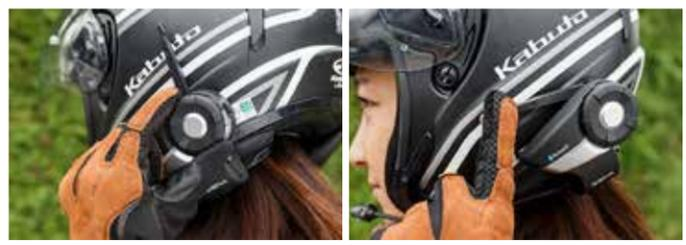
左上のジョグダイヤルは回転とタップの動作で、音量調整やインターコム通話の設定、メニューの呼出しができる。右上のアンテナは閉じられる。右下のフォンボタンでペアリングや電話応答、FMラジオの起動が可能
