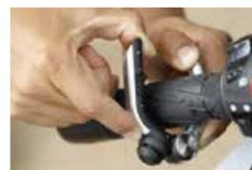
左側のハンドルグリップに取付けるのが基本。作業は前後ふたつのアームを開いてグリップを挟むようにするだけで簡単だ。アームが挟むバネの力でハンドルグリップを保持するだけだが、これで落ちるようなことはまずない。親指でジョイスティックが操作しやすい向きにするのがポイント
