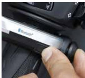
インターコム同士のペアリングや会話の開始、停止は、すべてフロントボタンに集約され、親指で操作する。セナのジョグダイヤルタイプのインターコムであれば、ジョグダイヤルボタンをタップする操作と同じだ
